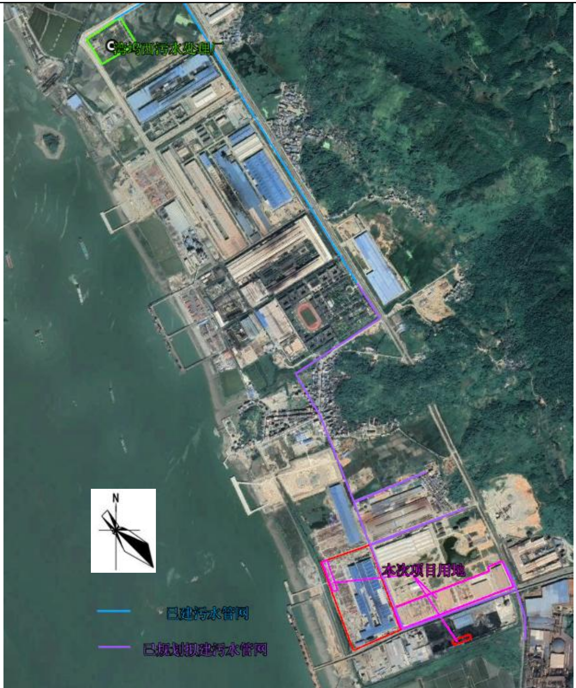
图 4.3-3 湾坞西污水厂污水收集管网走向
